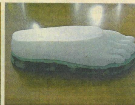
*I nuovi materiali a servizio dello sport: memorizzazione di una soletta in schiuma polimerica a memoria di forma mediante replica di un piede in Abs stampato 3D*
